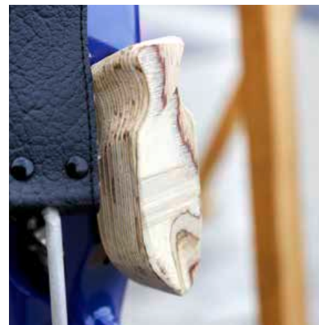
Ergonomie pur: Experten konstruieren mitunter eigene Anbauteile, wie diese Handauflage für den Stehendanschlag.
